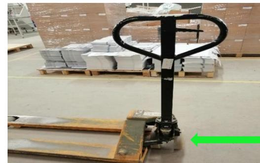
5- Pour mettre le transpalette à l'arrêt, mettre les roues sur le côté
