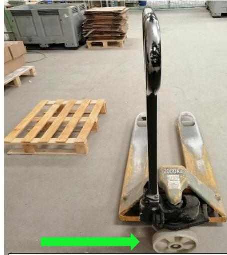
2- Mettre les roues sur le côté pour avancer
